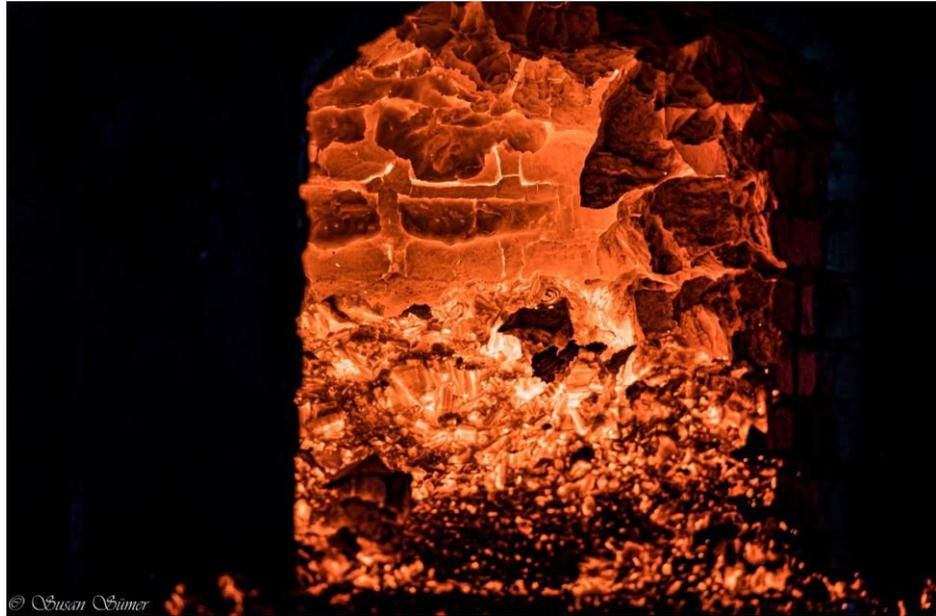
29. Wenn der Abkühlungsprozess startet, wird zusätzlich auch der Lehmdeckel entfernt und der befüllte Ofen einen vollen Tag ruhen gelassen, um auszukühlen.
