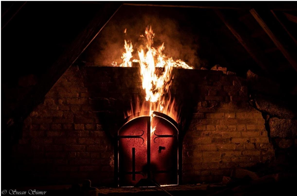
27. Nach circa 80 Stunden Befuerung wird die Glut durch die Schüröffnung aus dem Ofen geräumt, um die Abkühlung einzuleiten. Der Brennraum wird komplett geleert, um zu verhindern, dass die sich zusammenziehenden Steine mit Asche vermischen und so die Qualität des späteren Mörtels beeinflussen.
