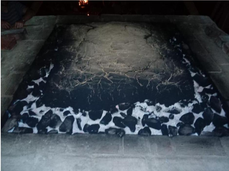
23. Beim Nachfeuern öffnet eine Person mittels eines langen Schiebers das Tor und eine zweite Person wirft Holz nach. Dies passiert im 15-Minuten-Takt. Die Hitzeabstrahlung auf der Vorderseite des Ofens ist hierbei erheblich und die Arbeit anstrengend.
