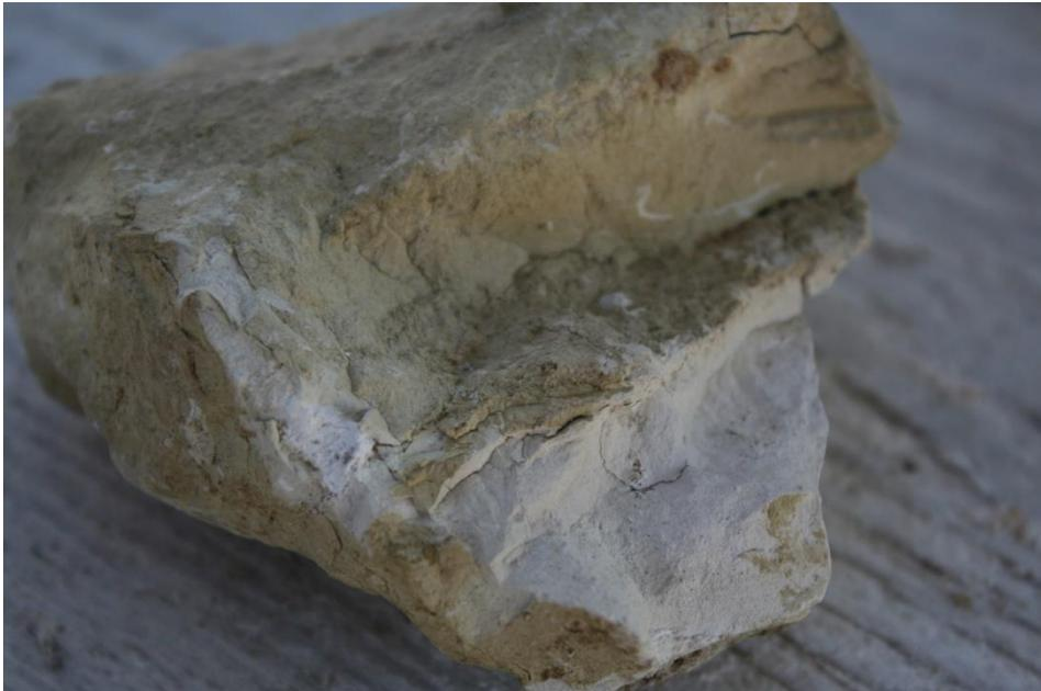
33. Wird der erkaltete Branntkalk nun mit kaltem Wasser übergossen, findet erneut eine chemische Reaktion statt, wobei scheinbar aus dem nichts Temperaturen von circa 160 Grad auftreten und es zu einer Volumenvergrößerung von 30% kommt.
