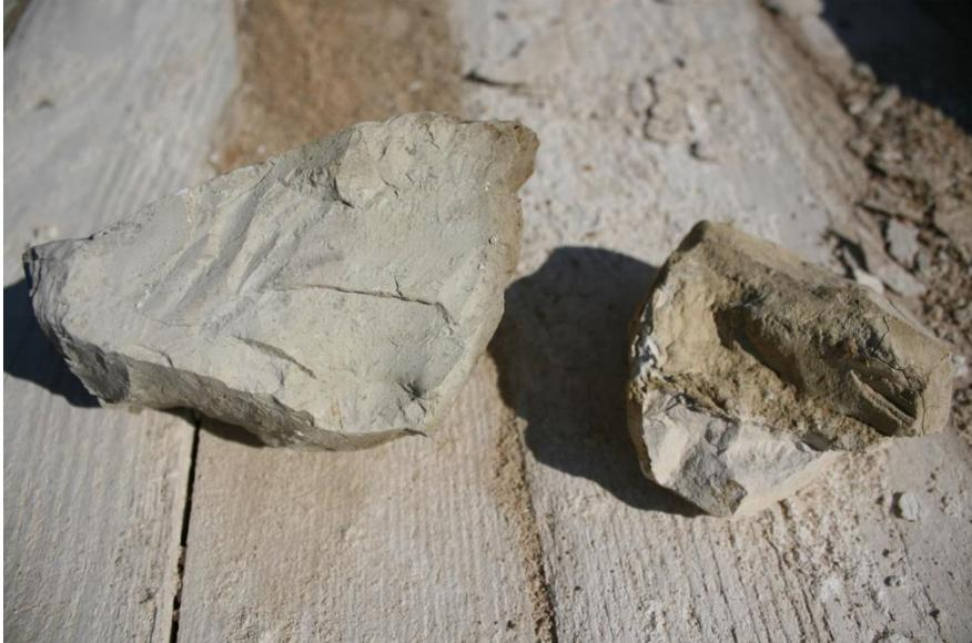
31. Das verwendete Grundmaterial des Prozesses ist ein Jurakalkstein mit einem Calciumgehalt von 85%, wie er oft als Treppenbelag oder zum Beispiel Fensterbank verbaut wird.
