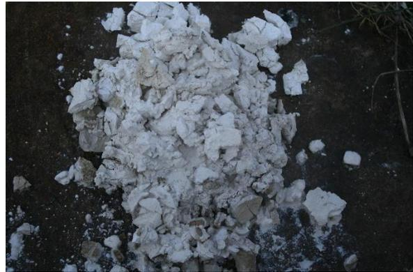
34. Nach circa 5 Minuten ist das Calciumoxid chemisch zu Calciumhydroxid umgewandelt. Je nach Menge der Wasserzugabe kann ein trockenes Pulver oder ein quarkähnlicher Brei entstehen. Sobald diese Umwandlung einmal abgeschlossen ist, hat der weitere Kontakt mit Wasser keine erneute Reaktion zur Folge.
