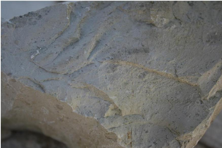
32. Das thermisch behandelte Material wird zu Branntkalk und unterscheidet sich deutlich vom Ausgangskalkstein. Die Oberfläche des Branntkalks erinnert vom Aussehen und Anfühlen an Kreide. Beim Brennen des Steins müssen mindestens 889 Grad Temperatur
